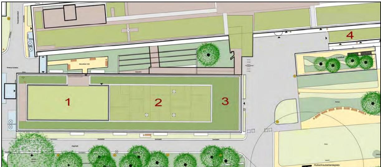
Der Neubau auf dem Standort ist mit Gründächern verschiedener Bauweise gedeckt. Auf dem U + B Trakt: **1** Technikraum, extensives Moos-Sedum-Dach mit Bauhöhe von max 8 cm. **2** Zentraler Dachbereich intensives Dachgrün mit sommergrünen Stauden. **3** Umlaufender Gehölzstreifen mit zu einer Fläche formierten Buxus. **4** Auf der Cafeteria des Neubaus extensives Moos-Sedum-Dach mit Bauhöhe von max 8 cm.
